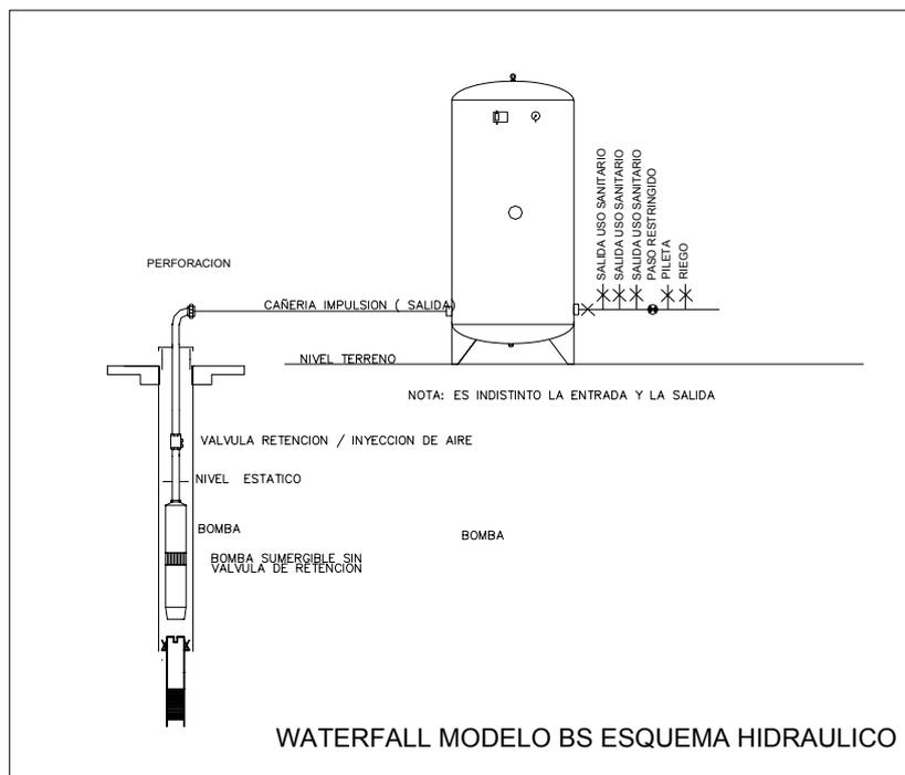
El sistema hidráulico propuesto permite una fácil operación sin complicadas maniobras para utilizar el riego y la piletta.
